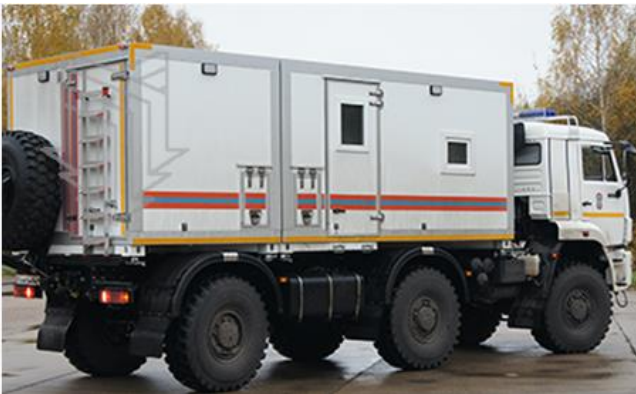
Аварийно-спасательный автомобиль АСМ-С-20 (43118) с колесной формулой 6х6, осевой формулой 1-1-1
