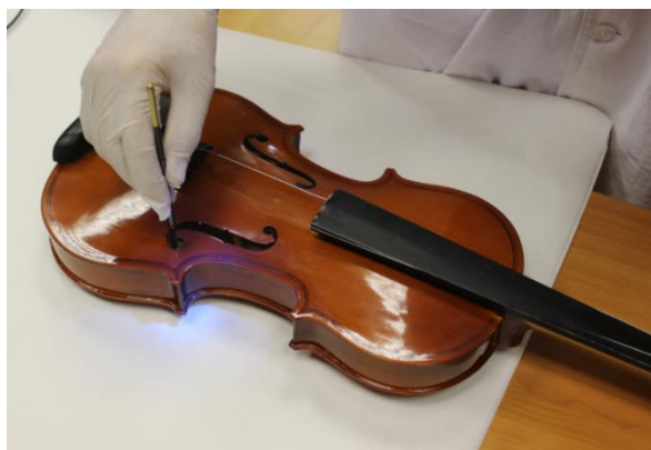
Рисунок 1 - Процесс нанесения маркировки на внутреннюю поверхность нижней деки
