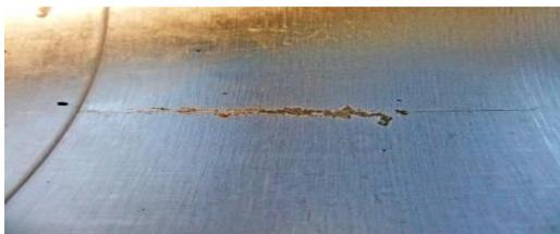
Таким образом, причиной разрушения изделий в процессе эксплуатации является разрушение хромового покрытия штока, появление задигов на поверхности корпуса и последующее зарождение в зоне задира усталостной трещины
