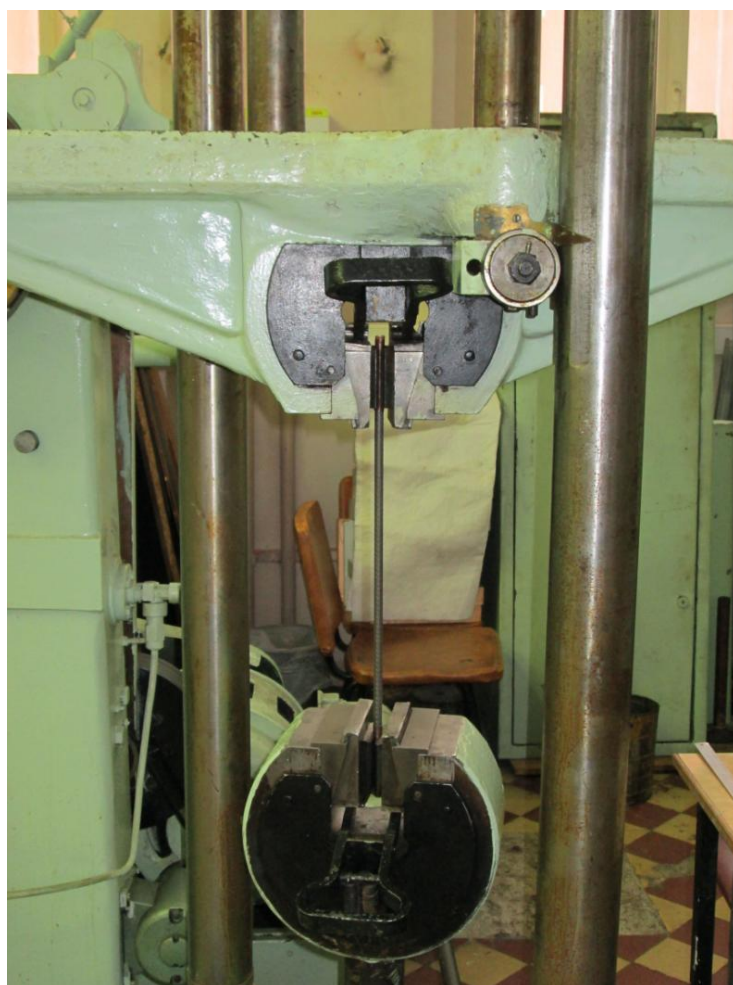
Рисунок 5 – Циклические испытания образцов арматурной стали
