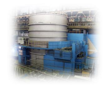
толстостенных конструкций с поперечными размерами до 10 м с современной цифровой системой управления, обеспечивающий высокий уровень автоматизации и безопасности при выполнении работ, который позволил проводить обработку в различных пространственных положениях элементов специальной техники для проектов «Борей», «Борей-А»,
