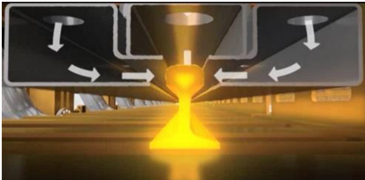
Рисунок 2 – Общая схема термической обработки рельсов воздухом с прокатного нагрева
