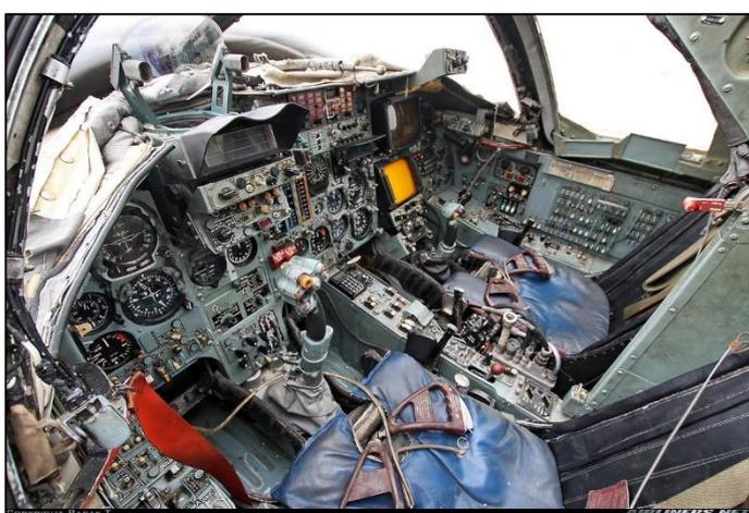
Для примера, на фотографии слева показана кабина одного из самолётов поколения 4-. Как видно на фотографии, информационно-управляющее поле кабины (ИУП) чрезвычайно загромождено. Анализ, обобщение и обработку информации с разных индикаторов лётчик должен был делать, в значительной мере, сам. Это приводило к сильной перегрузке лётчика, особенно при выполнении боевых задач.
