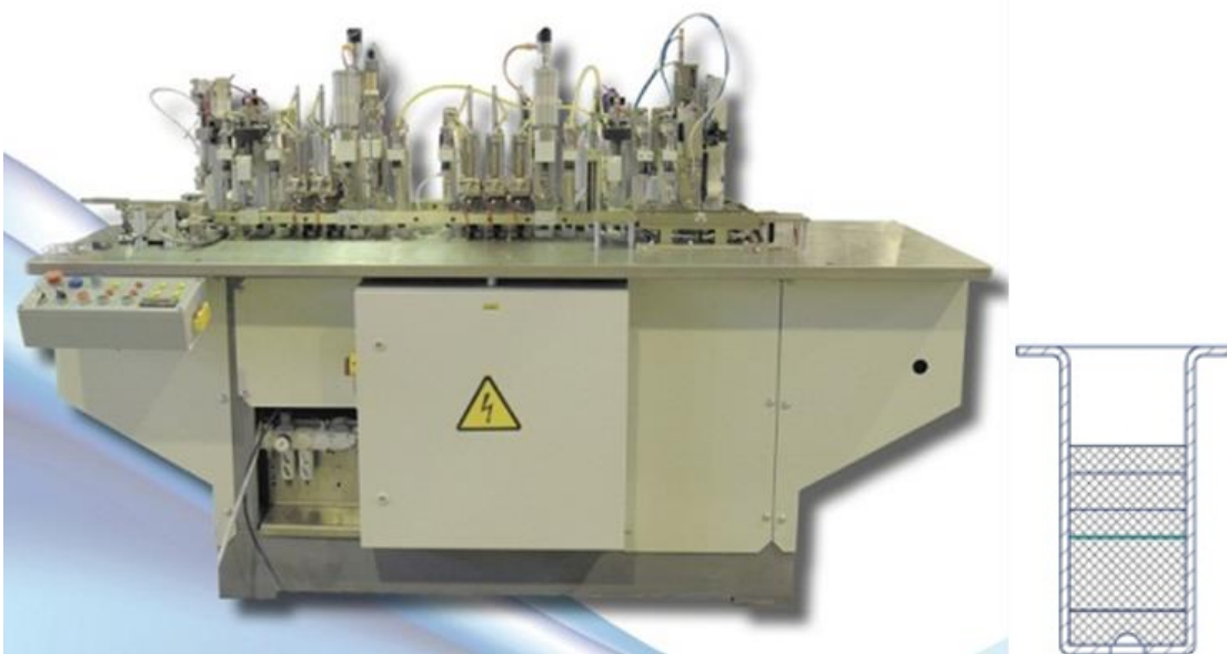
Рис. 3 Автоматическая линия запрессовки и контроля изделия «Стакан» и изделие
