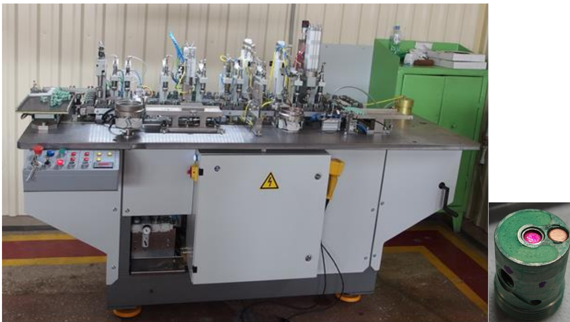
Рис. 2 Линия автоматическая сборки и контроля узла СБ7 и узел.
