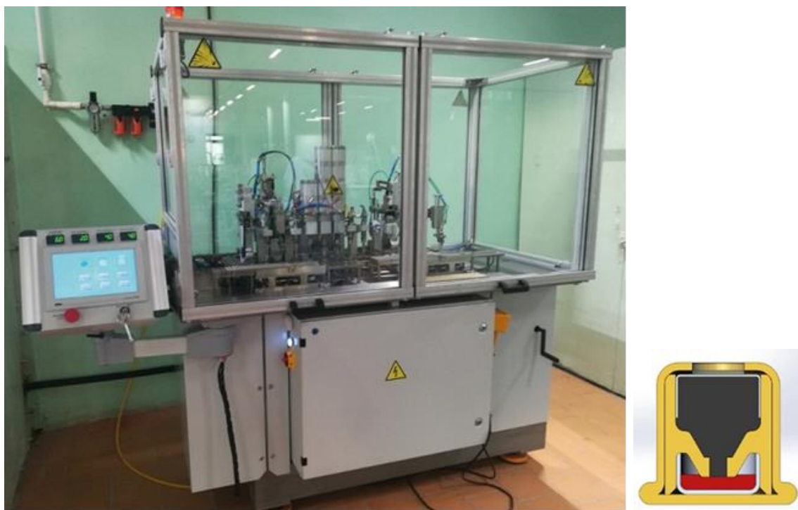
Рис. 1 Автоматическая линия сборки изделий КВГ-3 и изделие
