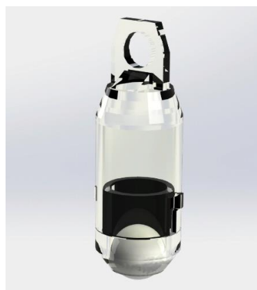
Иллюстрация используемой в приборе-тестере капсулы с феррозондом
