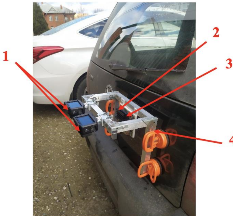
Аппаратный комплекс сбора данных: 1 – видеокамеры GoPro Hero7 Black (2 шт.); 2 – микрокомпьютер Jetson Nano; 3 – GPS-модуль; 4 – специальное крепление
